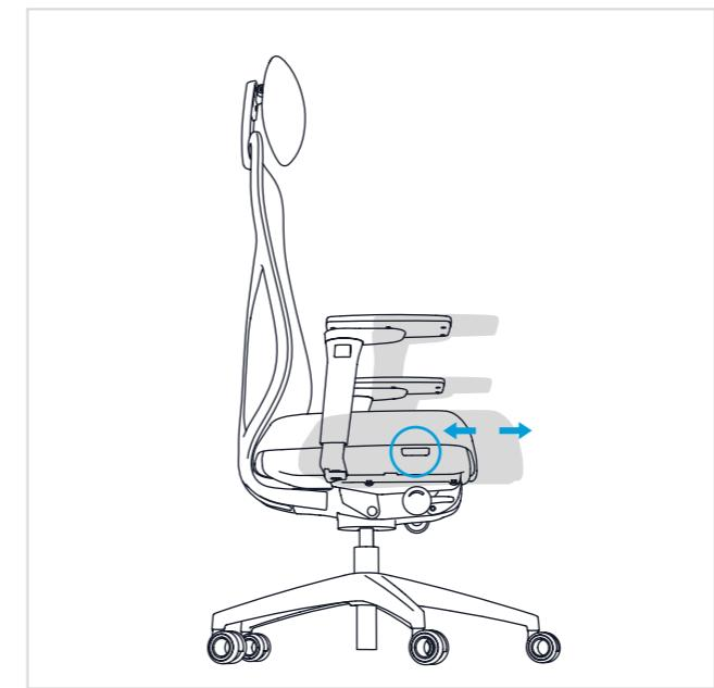
Bitte bei Erstnutzung den Hebel fest nach oben ziehen, um die Transportsicherung zu lösen.
